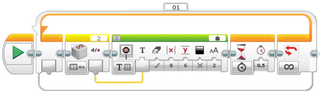
Agregamos un bloque bucle infinito.
